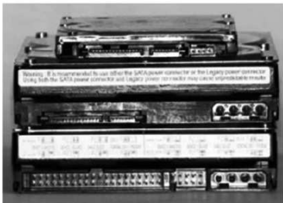
Slika 21 - Primeri IDE i SATA diskova [2]
