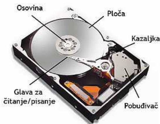
Slika 22 - Konstrukcija hard diska [24]
