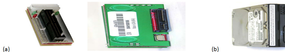
Slika 33 SATA adapter za sakupljanje podataka sa SATA diskova (a) i SATA adapter priključen na SATA disk (b)
