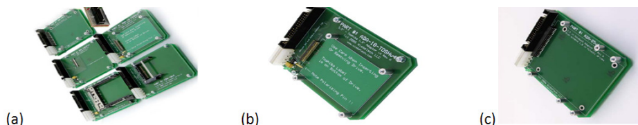
Slika 31 Sakupljanje podataka sa malih čvrstih diskova
