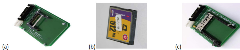
Slika 32 Sakupljanje podataka sa fleš memorije (a) mikrodiskova (b) i PCCard (PCMCIA) adapter(c)
