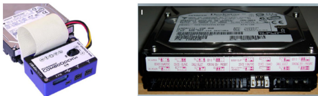
Slika 28 Sakupljanje podataka sa klasičnih 3,5 inča IDE diskova
