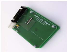
Slika 34 Adapter 1,8 inča ZIF za priključivanje Hitachi ZIF diskova
