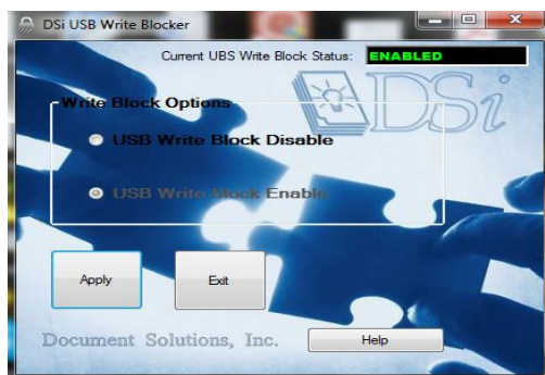
Slika 72: Softverski USB blokator upisivanja
