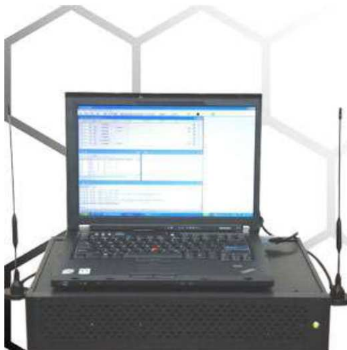
Slika 61. Komercijalni uređaj za prisluškivanje GSM saobraćaja
