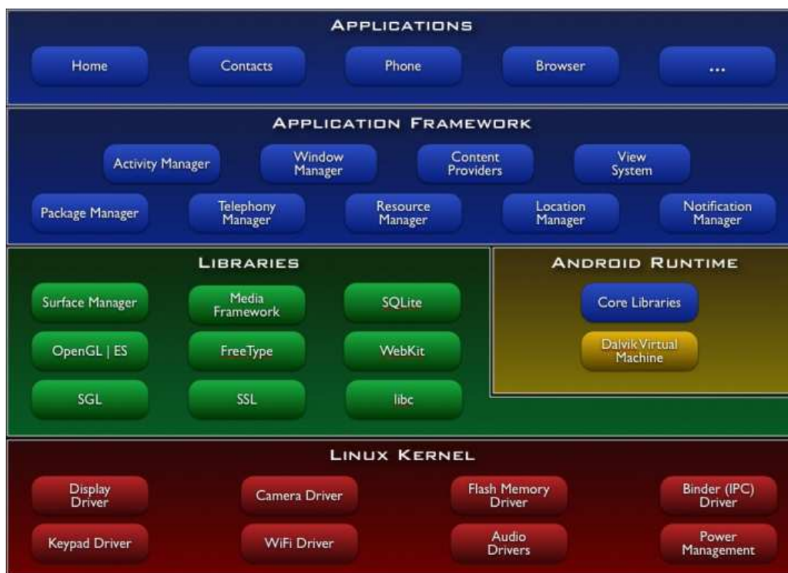
Slika 5. Arhitektura Android operativnog sistema [15]
