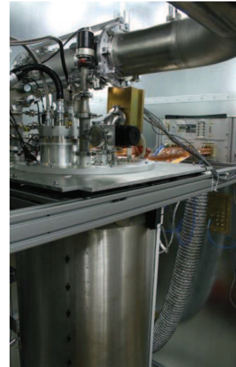
Slika 49 - D-Wave 2 - adiabatski kvantni računarски sistem i verzija Rainer procesora sa 128 qb
