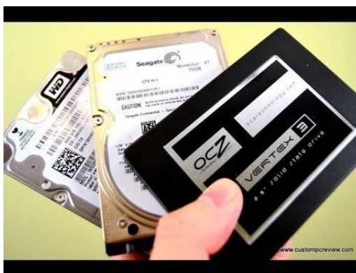
Slika 15 : Hibrid, HDD i SSD
