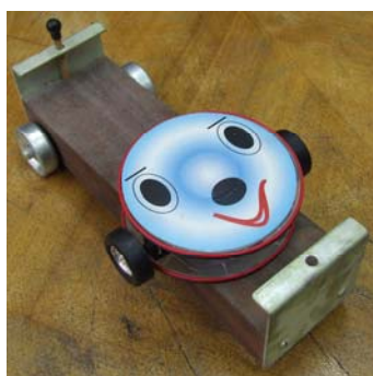
Slika 7.3.5a: Prikolica i robotizovana platforma odnos težina 5.8 : 1
