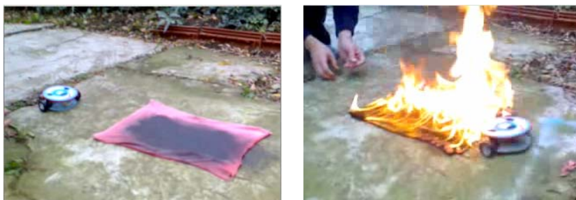
Slika 7.3.10: Vatreni poligon i prolazak platforme kroz vatru
