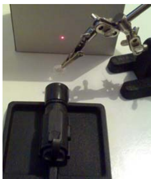
Slika A 3.3.1.1: Podešavanje senzora sa laboratorijskim laserom
