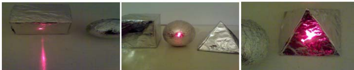
Slika A 3.3.1.2: Refleksija sa objekata koja smeta tačnim merenjima
