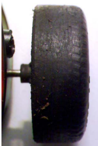
Slika 7.3.1.6: Točak robo platforme posle testa „prolaska kroz vatru“.
