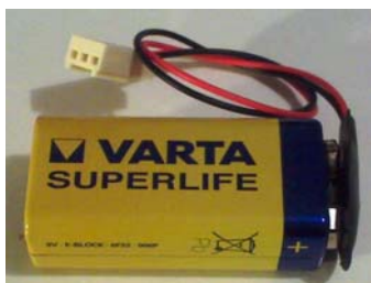
Slika 5.10.2.2: Izgled priključka za baterije tipa 6F22 i baterija sa priključkom
