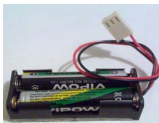
Slika 5.10.2.3: Izgled priključka za baterije tipa AAA i baterije u kućištu
