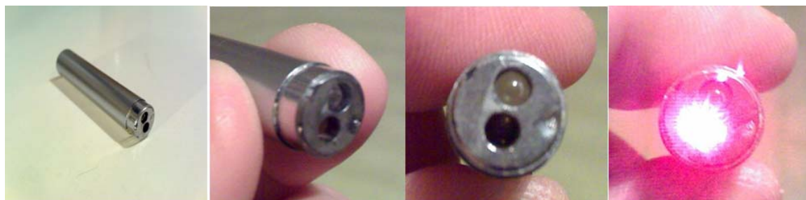
Slika 3.3.4: Prototip laserskog senzora bez filtera
