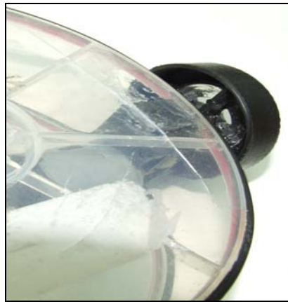
Slika 7.3.9: Pukotina na plastičnoj ploči koja nije ugrozila funkcionalnost platforme
