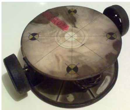
Slika 7.3.1.4: Robo platforma slikana posle testa „prolaska kroz vatru“.
