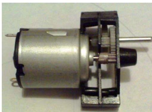
Slika 5.7.5: Projektovani reduktor u sklopu sa elektromotorom
