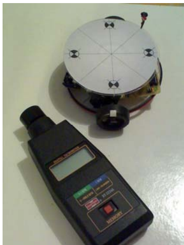
Slika 7.3.1.1: Testni model prilikom testiranja brzine kretanja robo platforme.
