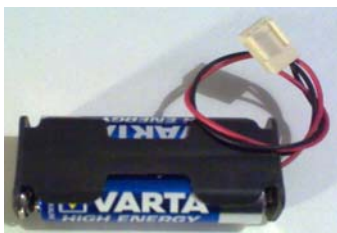
Slika 5.10.2.1: Dimenzije i izgled plastičnog kućišta za baterije tipa HR6 ili AA.
