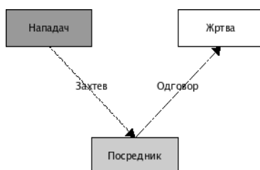
Слика 7. Модел рефлектованог напада са циљем онемогућавања услуге
