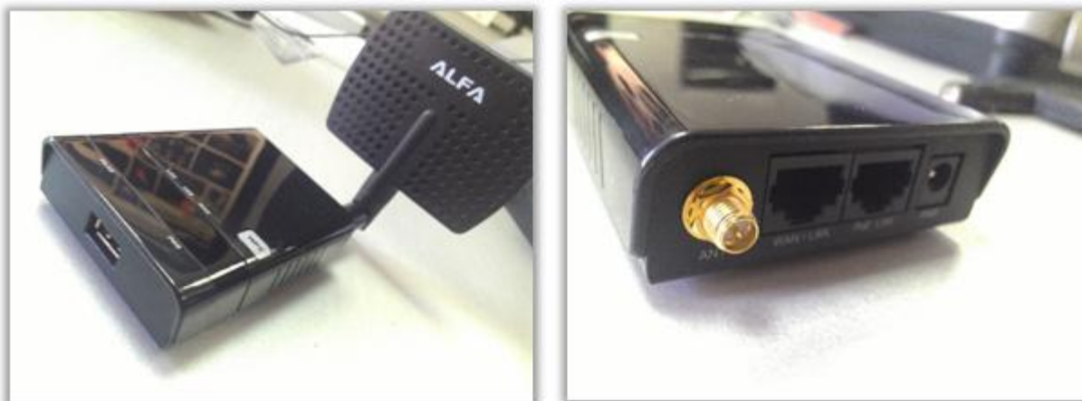
Slika 66: Fizička reprezentacija uređaja WiFi Pineapple Mark IV
