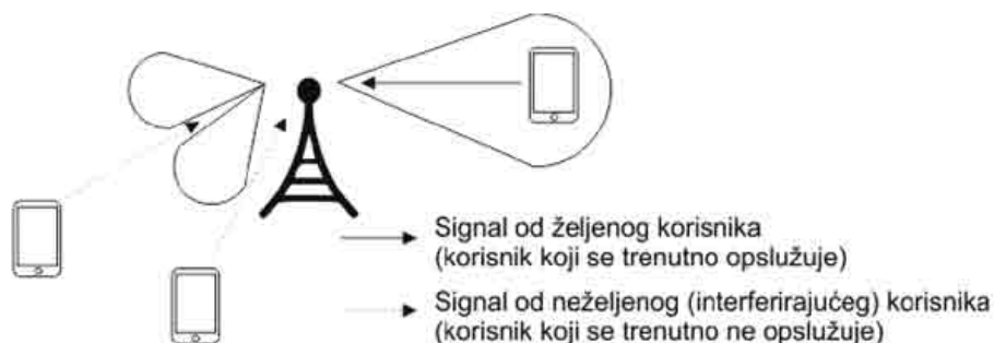
Slika 2.24 Formiranje i usmeravanjem listova zračenja i nula u karakteristici zračenja kod adaptivnih antenskih sistema
