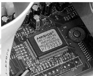
Slika 10. ROM memorijski modul, smešten na osnovnoj ploči računara
