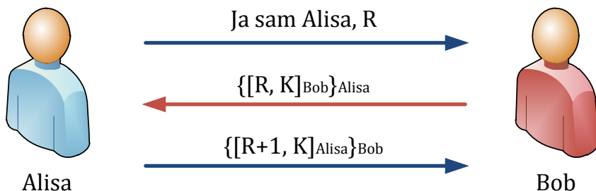
Slika 3.10 Protokol za uzajamnu autentifikaciju i uspostavu sesijskog ključa –potpisivanje i šifrovanje javnim ključem
