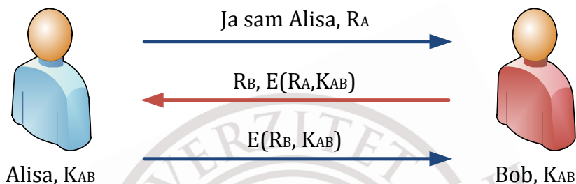
Slika 3.3 Uzajamna autentifikacija sa simetričnim ključem, 2
