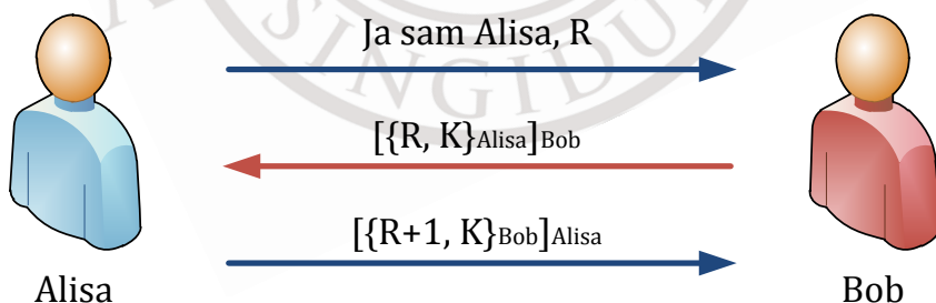
Slika 3.11 Protokol za uzajamnu autentifikaciju i uspostavu sesijskog ključa – šifrovanje javnim ključem i potpisivanje
