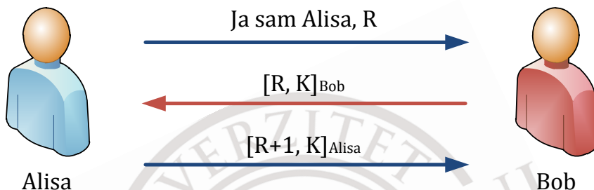
Slika 3.9 Protokol za autentifikaciju i uspostavu sesijskog ključa – digitalno potpisivanje
