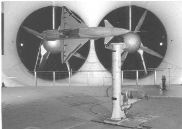
Слика 2. Модел авиона X-31 на уређају за мерење дериватива стабилности са принудним осциловањем у радном делу аеротунела NASA Langley 30x60-Ft (NASA L-94-08995)
