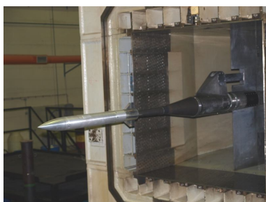
Слика 5. Модел MBFM у радном делу аеротунела Т-38
