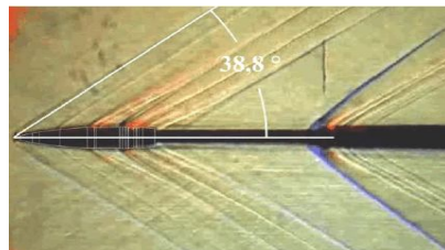
Slika 8. Širenje slike strujanja oko projektila za Ma=2,0 pri \alpha=0^\circ
