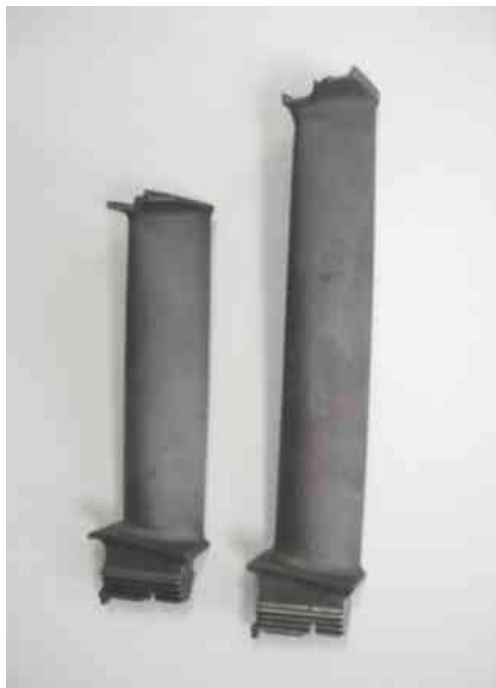
Slika 6. Izgled lopatica 1.i 2. stepena rotora turbine nakon izdržanih 450 ciklusa termocikličnog zamora
