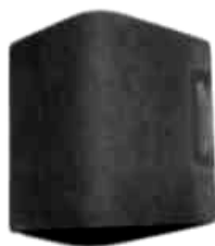
Slika 2. Izgled savijene epruvete sa prevlakom pod uglom od 90°
