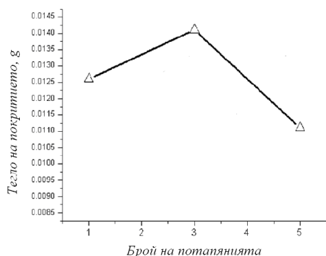
Фиг. 3. Промяна в теглото на образците след нанасяне на зол-гел слоя в зависимост от броя на потапянията
