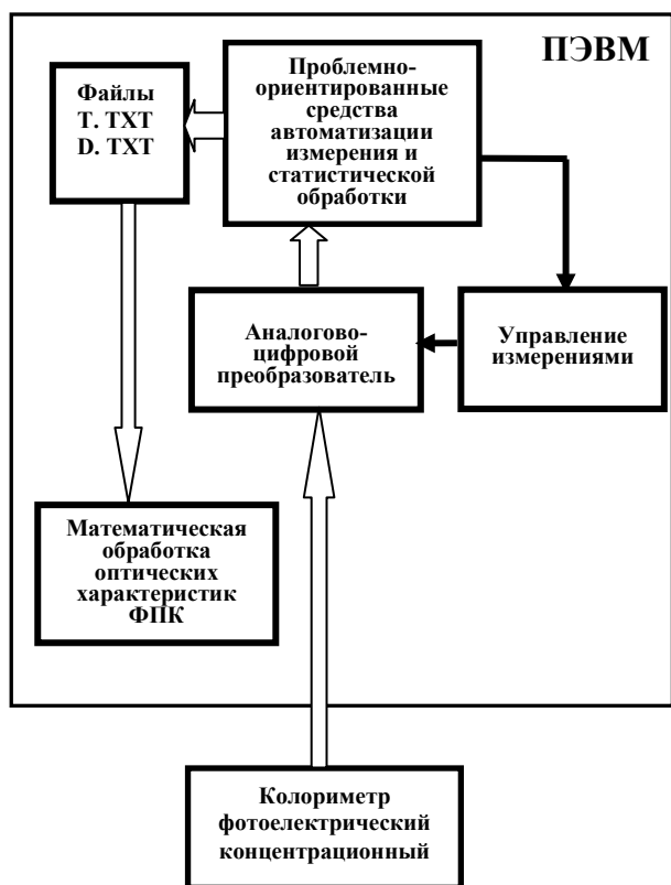
Рис. 1. Структурная схема средств автоматизации измерения и статистического определения оптических характеристик ФПК
