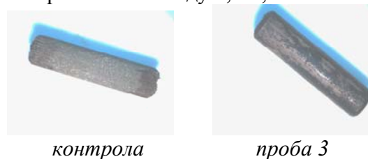
Фиг. 2. Външен вид на образците, третиран в 10%HCl в продължение на 72 часа.
