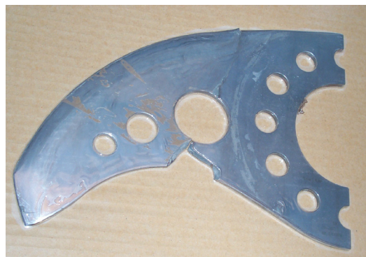
Abb.: 2. Kuttermesser mit Bruch am Messerrücken
