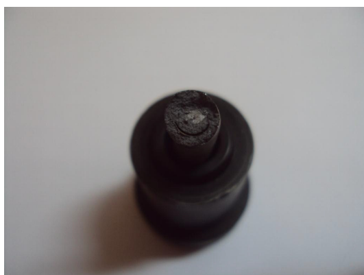
фиг. 5 Разслояване след синтероване
