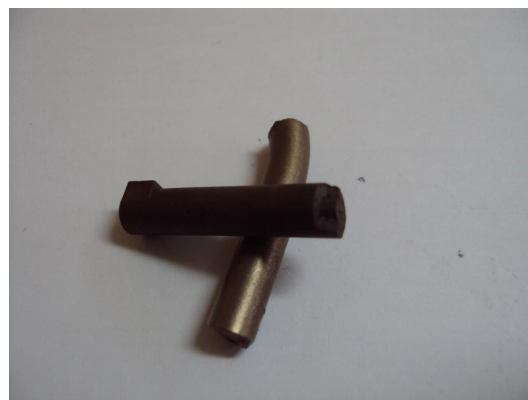
Фиг. 2. Разслояване на заготовката
