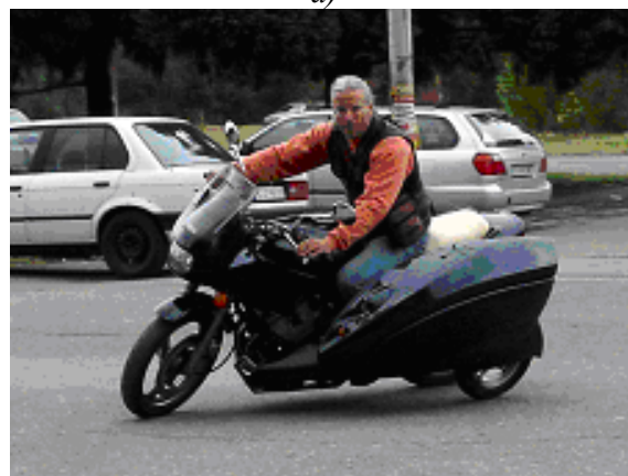
Фиг. 6. Изпитвания на новата триколка [8] при десен (a) и при ляв (б) завои
