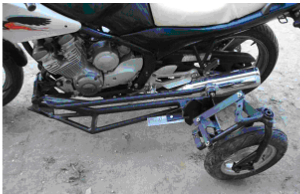
Фиг. 7. Окачването на третото колело в новата асиметрична триколка
