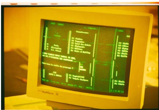
Слика бр.1: Реконструисани садржај екрана рачунара на основу радијационог компромићујућег ЕМ зрачења.
