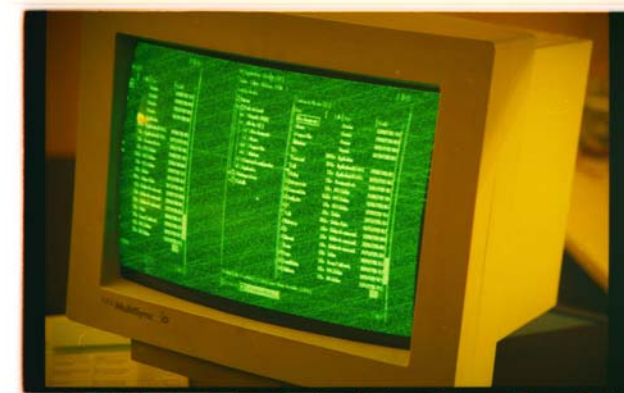
Слика бр.2: Реконструисани садржај екрана рачунара на основу радијационог компромићујућег ЕМ зрачења.
