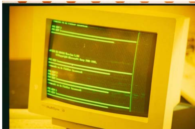
Слика бр.3: Реконструисани садржај екрана рачунара на основу радијационог компромићујућег ЕМ зрачења.
