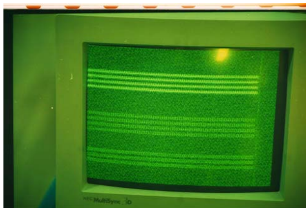
Слика бр.4: Реконструисани садржај екрана рачунара на основу кондукционог компромићујућег ЕМ зрачења .
